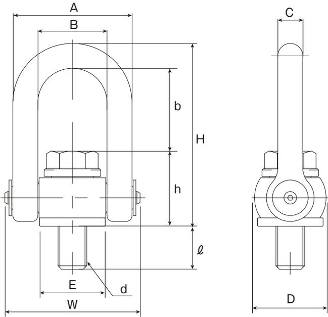
※2個以上のマルチアイボルトを使用しての荷役の時は、つり角度による張力増加係数を加味した使用荷重の範囲内でご使用ください。また取付けに際しては、本品の座面と荷役物体の間に厚ワッシャ等をはさむ取付けは使用荷重を激減させるため保証ができません。
